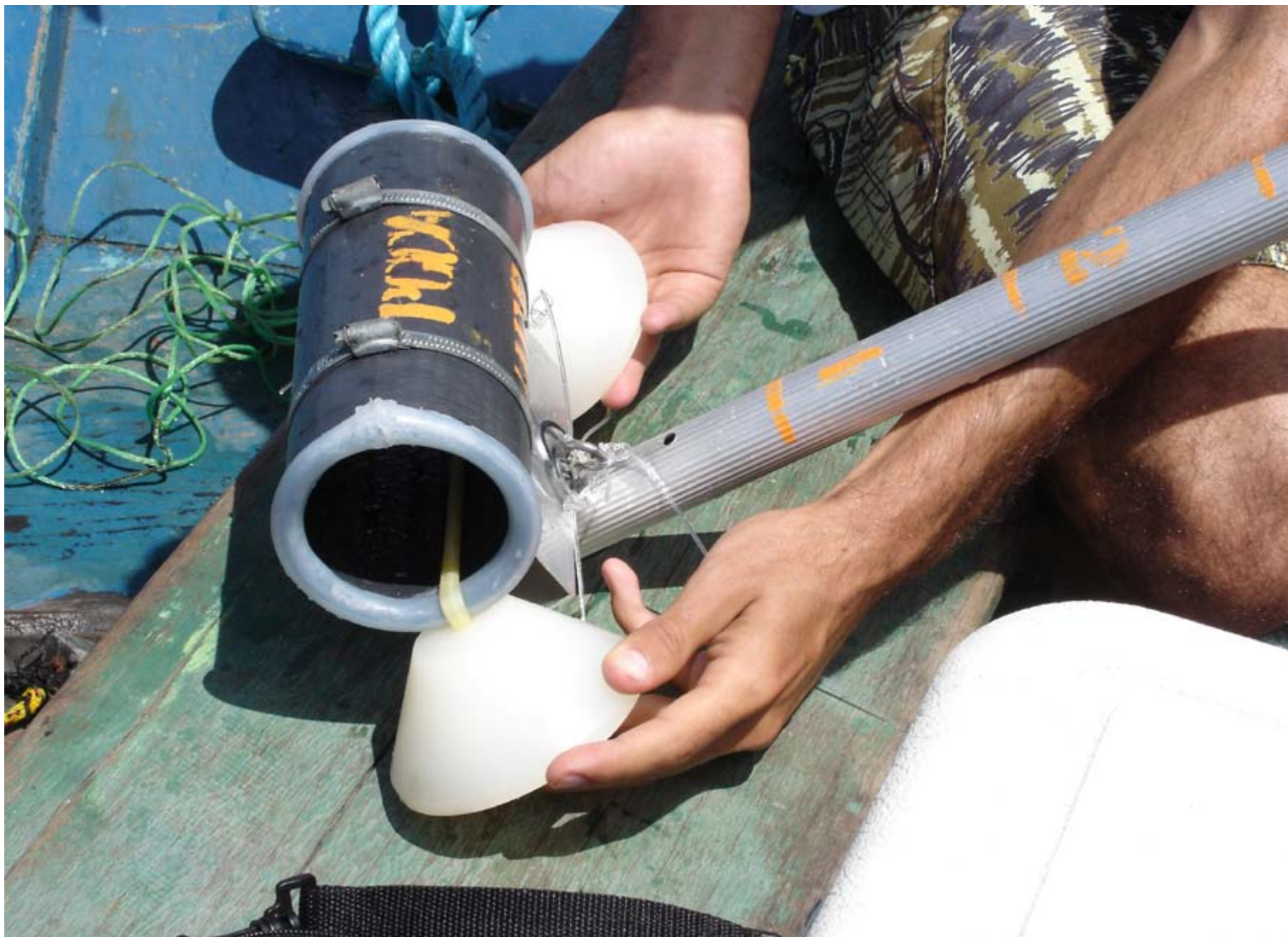
Amostrador de água, um coletor específico para águas rasas, desenvolvido e patenteado pela UFF
