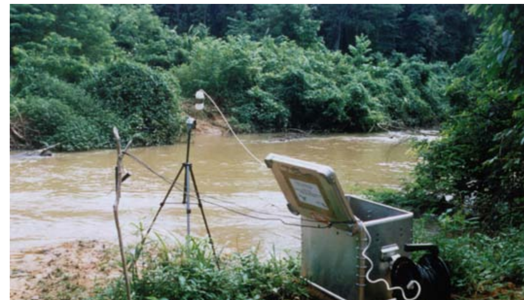
Guyana, aparelho que faz medições de mercúrio volátil na atmosfera da Amazônia
